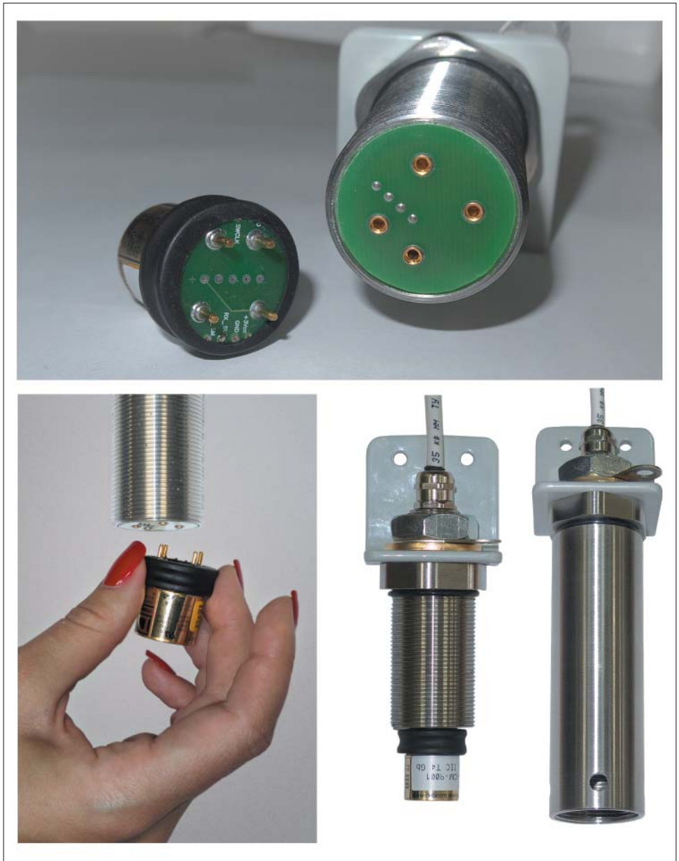
Рис.2. Подключение интеллектуального сенсорного модуля
