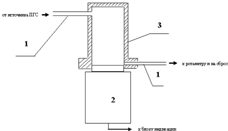
1 – соединительные трубки; 2 – блок датчиков; 3 – адаптер
