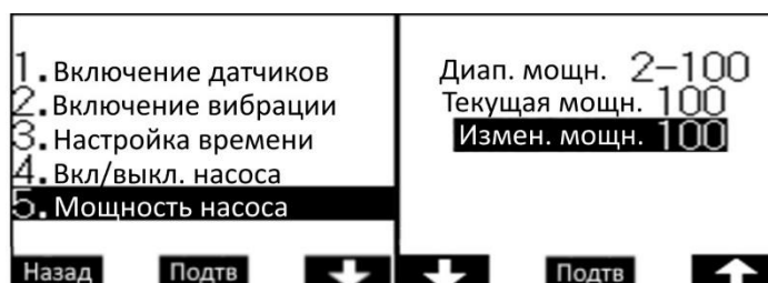
Рис. 10. Настройка мощности прокачки насоса
