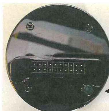
Рисунок 2 – Схема пломбировки от несанкционированного доступа
