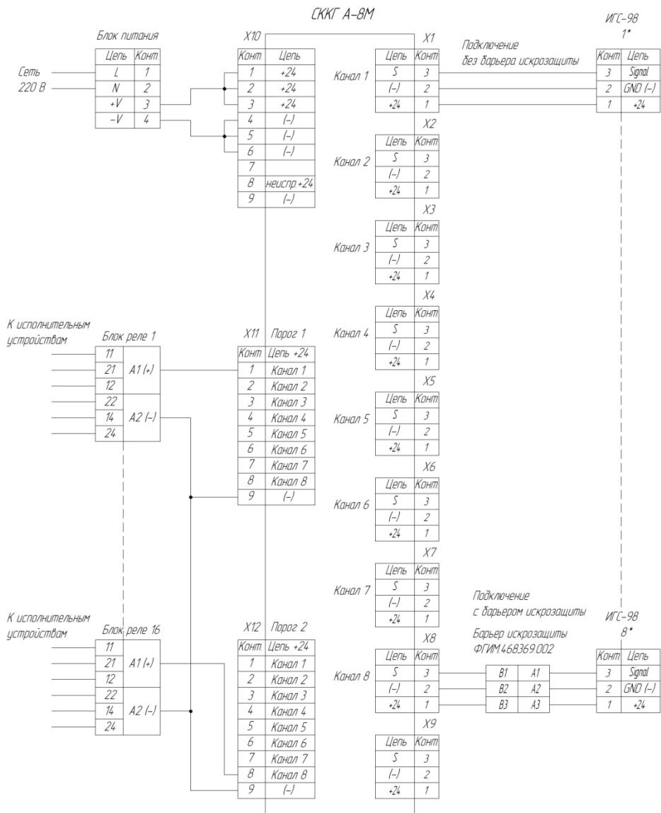
\* Для разных типов датчиков своя маркировка контактов
