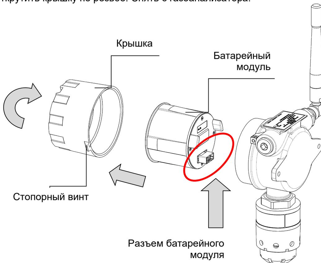
Рисунок 20- Схема разбора газоанализатора для активации (вид сзади)
