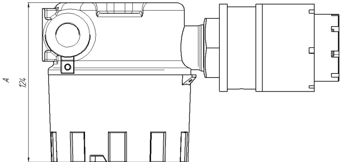
Рисунок Г.1 - Габаритный чертеж ДГС ЭРИС-210
