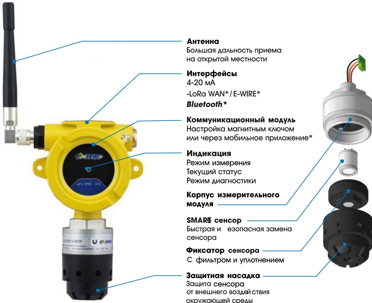
Беспроводной одноканальный газоанализатор с автономным питанием и передачей данных по радиоканалу. Позволяет обеспечивать безопасность в местах отсутствия инженерных сетей. Служит для подачи предупредительной сигнализации о превышении установленных пороговых значений концентраций взрывоопасных, токсичных газов, кислорода и диоксида углерода в воздухе рабочей зоны.
