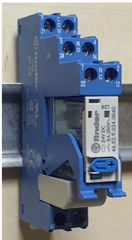
Рисунок 5. Внешний вид и схема модулей реле 4С.02.9.024.0050.SPA
