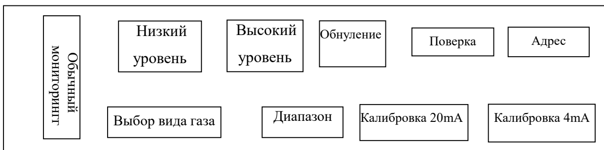
Рис 10 : Схематическое отображение циклической работы
