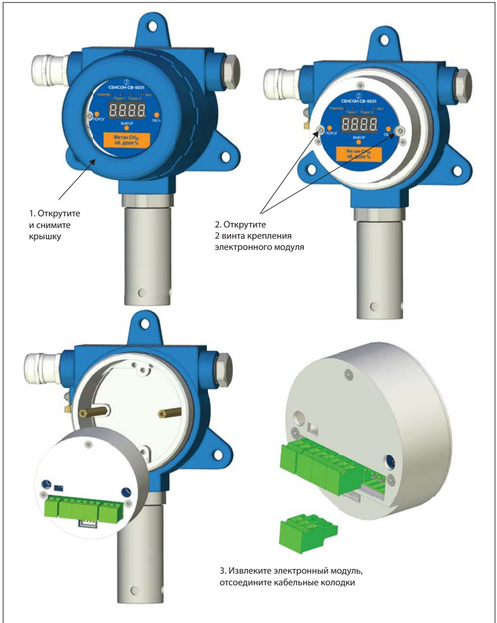
Рис. 10. Порядок разборки МКТИ-2
