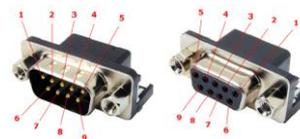
*Примечания:* 1. Электрическое сопротивление каждого провода, соединяющего контакты разъемов датчика и блока информационного 1 – 1 и 3 – 5, не должно превышать 40 Ом.
