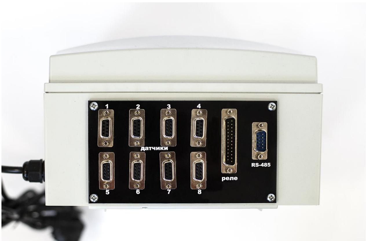
**Рис.2.2 Вид задней панели блока информационного СИГМА-03.ИПК 8.4/8.8 (RS)**
