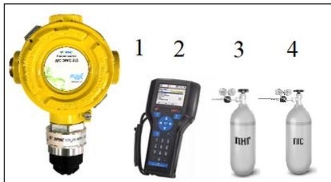
Если окружающий воздух НЕЛЬЗЯ использовать в качестве надежного калибровочного газа для установки НУЛЯ, то необходимо снять влагозащитную насадку, установить на датчик калибровочную насадку (см. раздел 5) и подключить к нему ПНГ.
