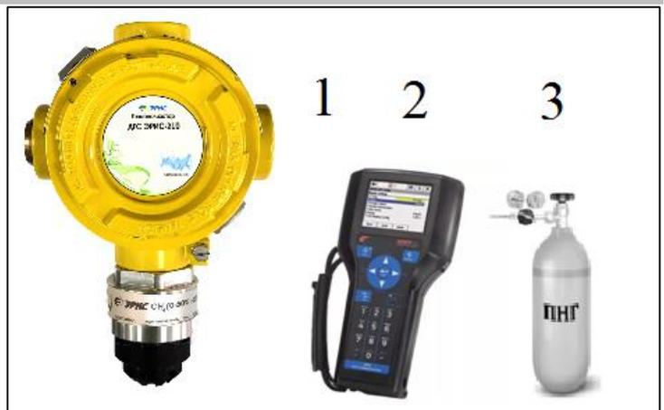
② Включить HART коммуникатор (при необходимости, перейти из главного меню в раздел настройки соединения) и дождаться установления связи с газоанализатором.
