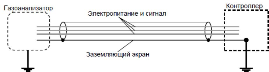
Рисунок 8 – Заземление экранированного кабеля
