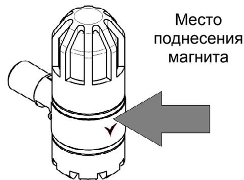
Рисунок К.3 – Место поднесения магнита к С30
