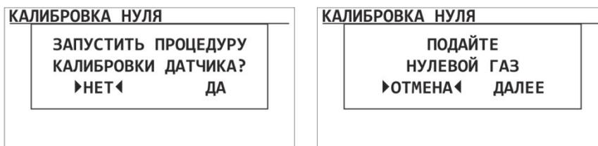
Процедура калибровки нуля длится минимум 30 с. После этого необходимо сохранить калибровочные параметры. По окончании калибровки на дисплее высвечивается статус «Завершение калибровки датчика» в течение нескольких секунд. Затем датчик переходит обратно в меню «Калибровка».
