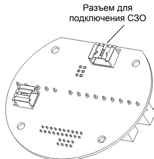
Рисунок К.1 – Разъем для подключения светозвукового оповещателя
