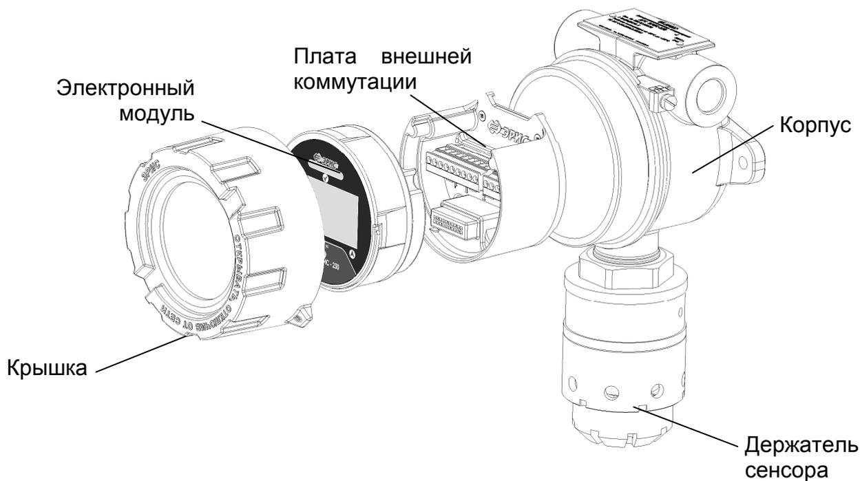
Рисунок 3 – Функциональный состав ДГС ЭРИС-230
