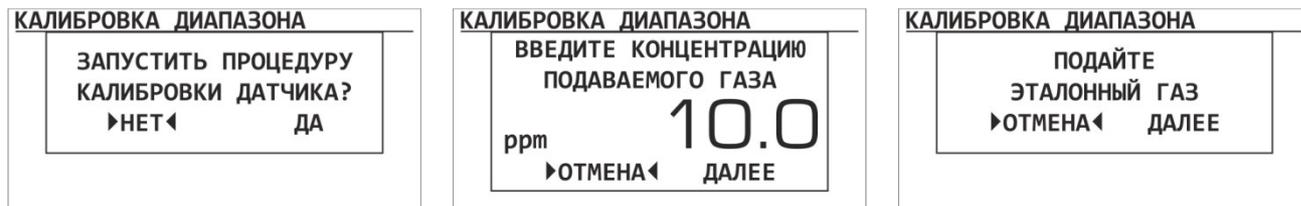
Процедура калибровки диапазона длится минимум 30 с. После этого необходимо сохранить калибровочные параметры. По окончании калибровки на дисплее высвечивается статус «Завершение калибровки датчика» в течение нескольких секунд. Затем датчик переходит обратно в меню «Калибровка».
