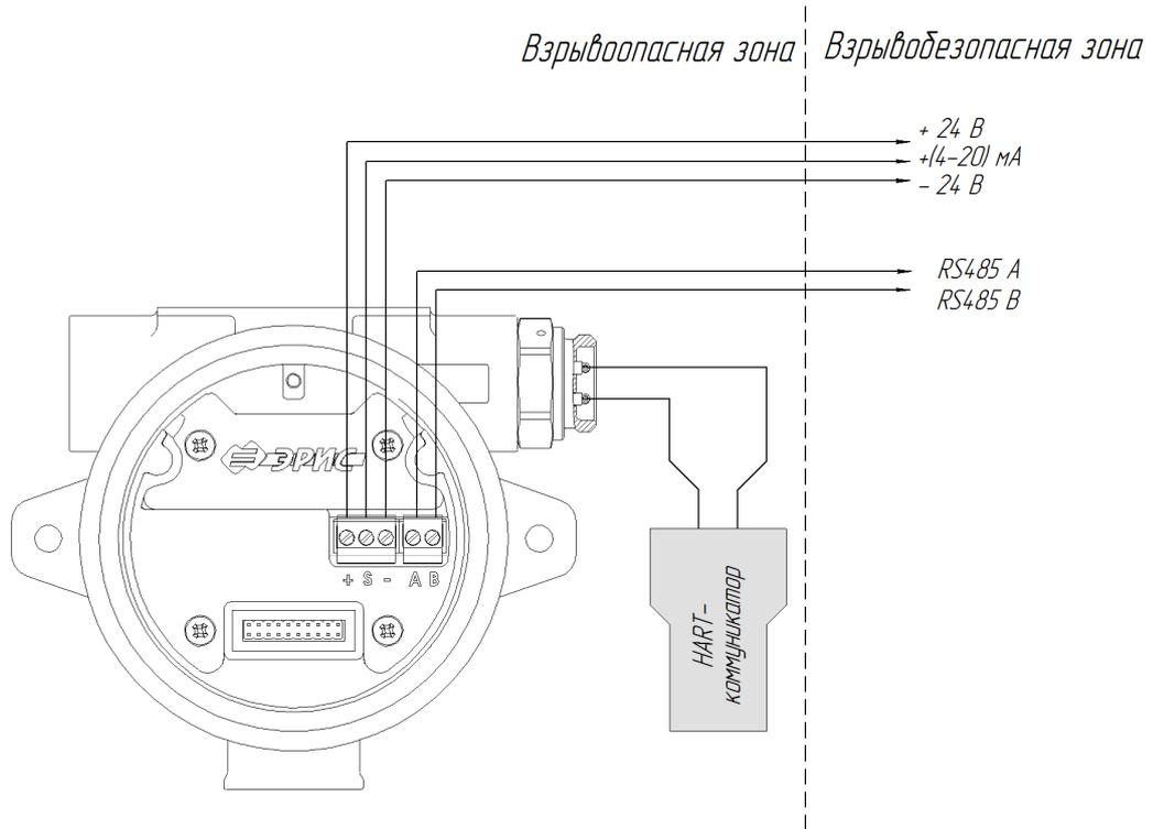
Рисунок Б.3 – 3-проводная схема подключения газоанализатора ДГС ЭРИС-230 без реле и с подключением локального HART
