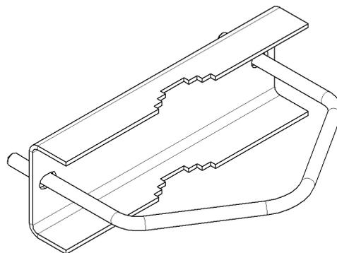
Рисунок Л.2 – Комплект для монтажа на трубу
